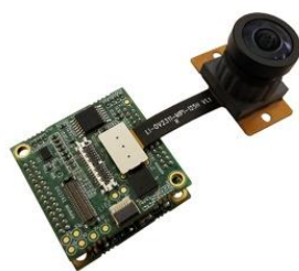
Abbildung 8: Infrarotkamera mit Sensor Leopard Imaging OV2311
