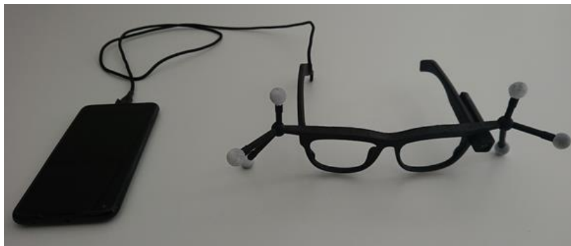
Abbildung 7: Pupil Invisible Brille mit Smartphone zur Aufzeichnung und individuellem 3D Ausdruck mit Motion Capture Kugeln
