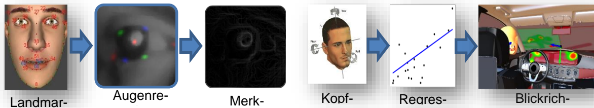
Abbildung 18 Blickrichtung mittels Regressors auf Bildmerkmalen
