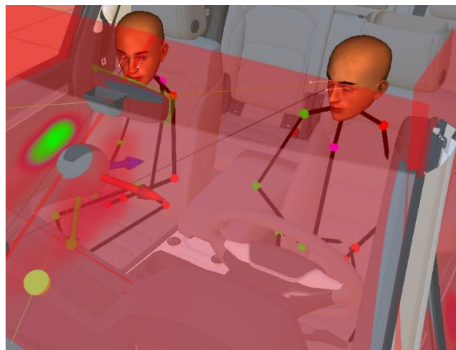
Abbildung 25: Visualisierung der 3D Repräsentation der Körperpose im Virtual Showroom
