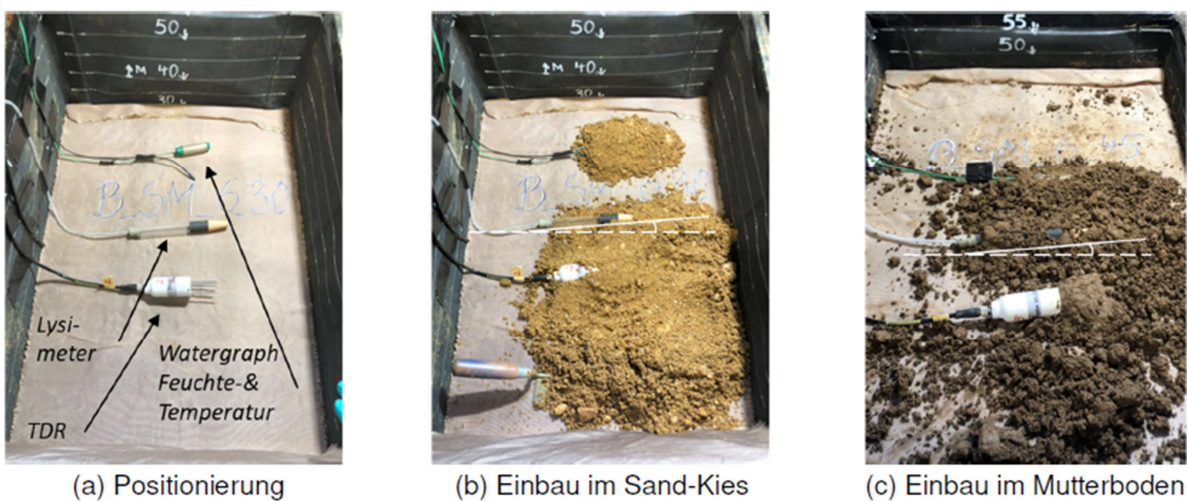
Abbildung 8. Einbau der Messtechnik in den Abbauersuchen
