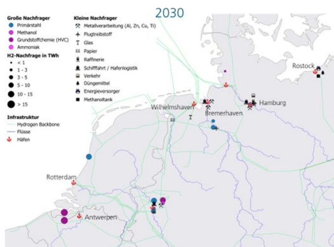
Abbildung 3: Darstellung der identifizierten voraussichtlich ersten großskaligen Nutzer von Wasserstoff oder Derivaten sowie möglichen kleinen Abnehmern in Hafennähe bis 2030
