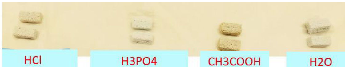
Abbildung 4: Nachweis der Beschichtung an unterschiedlich vorbehandelten Proben bei Verwendung aminhaltiger Polyelektrolyte anhand der mit Ninhydrin entstehenden Verfärbung. Die Verfärbung ist hier bei den mit HCl (Salzsäure) und CH 3 COOH (Essigsäure) vorbehandelten Proben zu erkennen.
