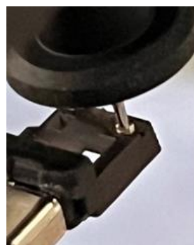
Abb. 15: Beispiel für Positionierungsfehler in früheren SPE-Steckverbinderkonstruktionen
