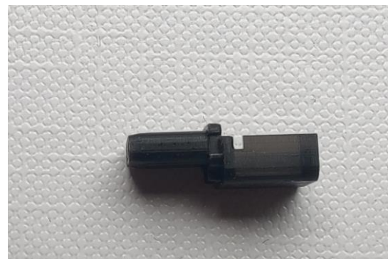
Abb. 13: Ausgangsvariante des Grundkörpers des SPE-Steckverbinders
