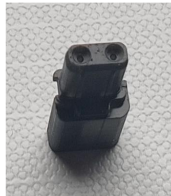
Abb. 14: weiterentwickelter Grundkörper des SPE-Steckverbinders
