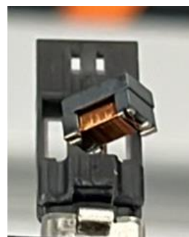
Abb. 15: Beispiel für Positionierungsfehler in früheren SPE-Steckverbinderkonstruktionen
