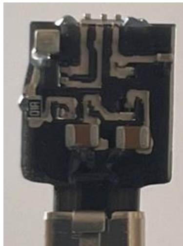
Draufsicht auf den Grundkörper mit gedruckter elektrischer Schaltung und bestückten Bauteilen
