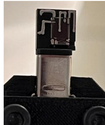
Abb. 16: Automatisiert eingesetzter und fixierter Transformator (links) und aufgedruckte Leiterbahnen an den Kontaktpads
