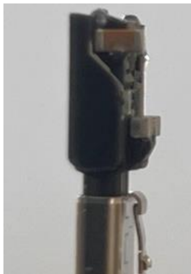
Seitenansicht des Grundkörpers mit gedruckter elektrischer Schaltung und bestückten Bauteilen
