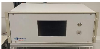
Abbildung 5: Mobiles GC-IMS nach den Anforderungen aus AP 2.1
