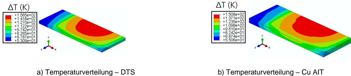
Abbildung 11: Temperaturverteilung auf dem Chip von DTS- und Cu-AIT-Leistungsmodulen
