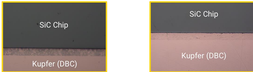
Abbildung 7: Fehleranalyse nach dem Lastwechseltest für gemoldete und ungemoldete Prüflinge mit verbesserter AVT – kleine Risse erkennbar (roter Pfeil)
