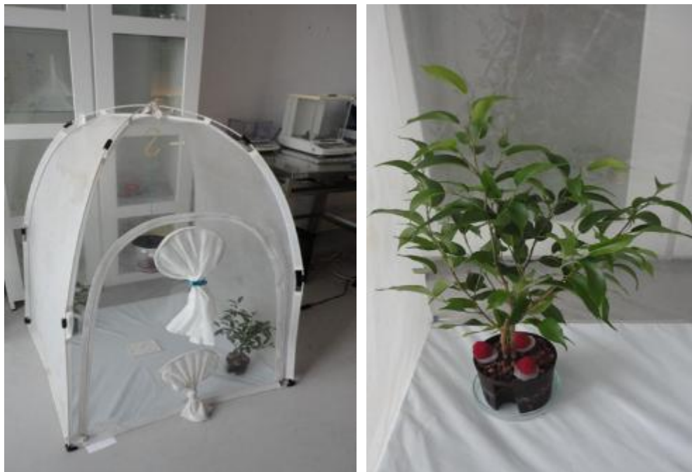
Abbildung 53: Links: simulated-use Versuch im großem Gazezelt, Wassertränke, Lockstofffalle und zwei Pflanzen mit je drei Himbeeren; rechts: Pflanze mit den Wirtsfrüchten vergrößert dargestellt.
