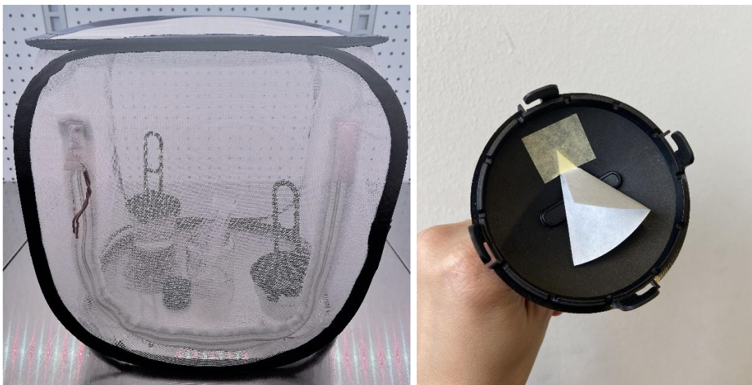
Abbildung 1: Links: Versuchsaufbau double choice Versuche; rechts: Filterpapier unter dem Fallendeckel zur Applikation der Duftstoffe.
