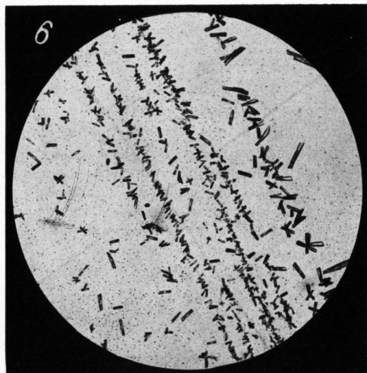
Bild 1 bis 6. Mikrophotographien von Zink-Mercurirhodanid-Kristallen bei abnehmenden Zinkkonzentrationen; Vergrößerung 95 fach. (Erläuterungen im Text bei Nr. 2 bis 6.)
