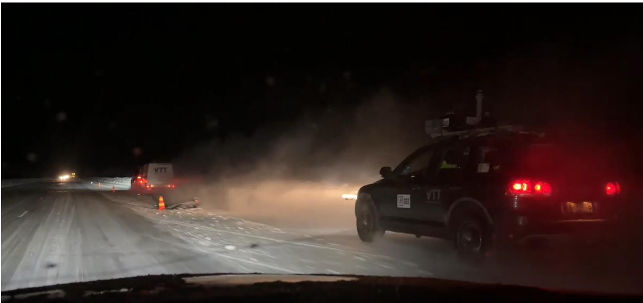
Abbildung 10: Lost Cargo Testszenario unter Schneebedingungen in der Lappland Messkampagne
