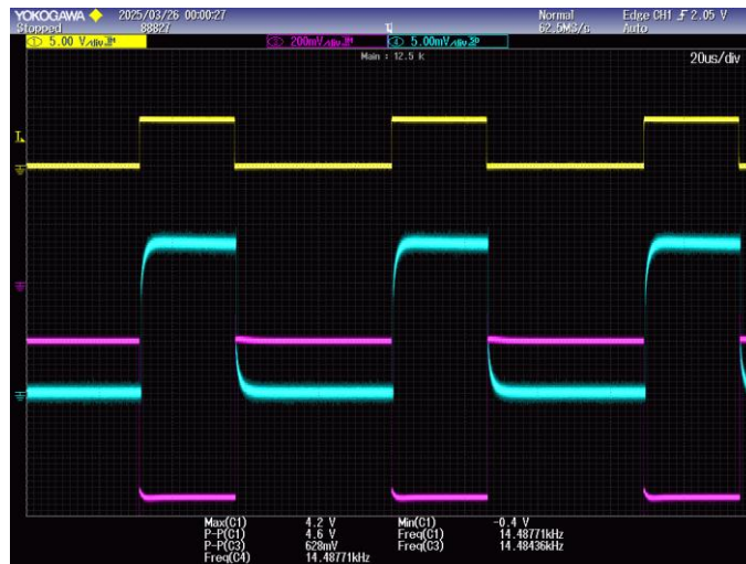
Abbildung 73: Photodiodesignal vom EDFA in Blau, EOM-Ansteuerungssignal in pink, AOM-Signal in Gelb.
