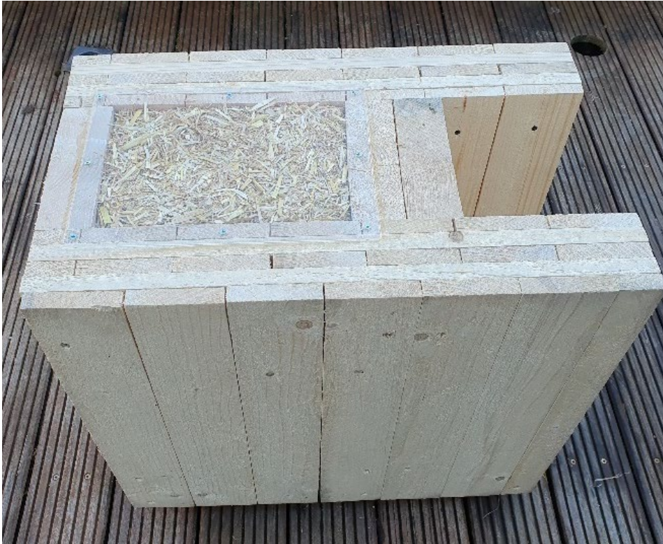
Abb. 3: Probekörper für die Wandkonstruktion (eigenes Foto – händische Herstellung eines potenziellen Wandaufbaus von 2 Massivholzplatten auf einem tragenden Holzständer mit eingeblassener Strohdämmung)
