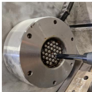
Abbildung 17: Signalemission mit dem Rückprallhammer an der Verankerung.
