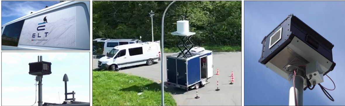
Abbildung 5.2: RF-Sensor, ELT-Sprinter und Radar Elvira während der Messkampagne
