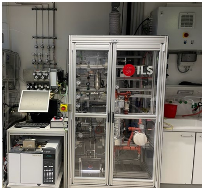
Abbildung 11: 1L-JLR der Firma ILS mit Anbindung an das Gas-, Elektrizitäts-, Sicherheits- und Netzwerksystem.
