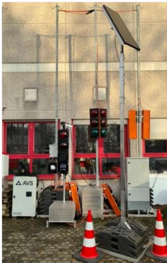
Abbildung 19: Versuchsaufbau der Energy-Harvesting-Messung
