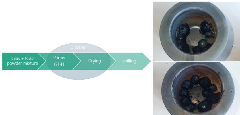
Abbildung 23 Mischungsherstellung aus Glas- und Rutheniumdioxidpulver: Zugabe und Eintrocknen des Primers GE141 in 3 Zyklen und anschließende Mischmahlung in der Planetenkugelmühle
