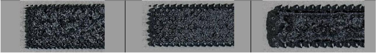
Abbildung 15 Druckbild der gravurgedruckten W24123-Schichten mit einem Schöpfvolumen von 6, 12 und 18 ml/m 2 (v.l.n.r.), Quelle: ViaElectronic
