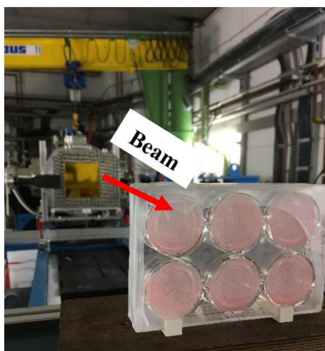
Abb. 2: Neu etabliertes Setup für Weltraum-relevante Experimente, bei dem Platten stehend bestrahlt werden.
