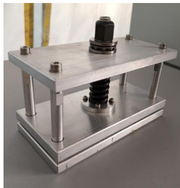
Abbildung 17: Elektrochemische Performance der verspannten Pouchzellen (Si@Gr/C); Oben links: C-Raten-Test; Oben rechts: Langzeitzyklisierung; Unten: Zellpresse zur Verspannung der Pouchzellen; Zur Einstellung des Drucks werden die Passscheiben zwischen der oberen Platte und der Feder eingesetzt.
