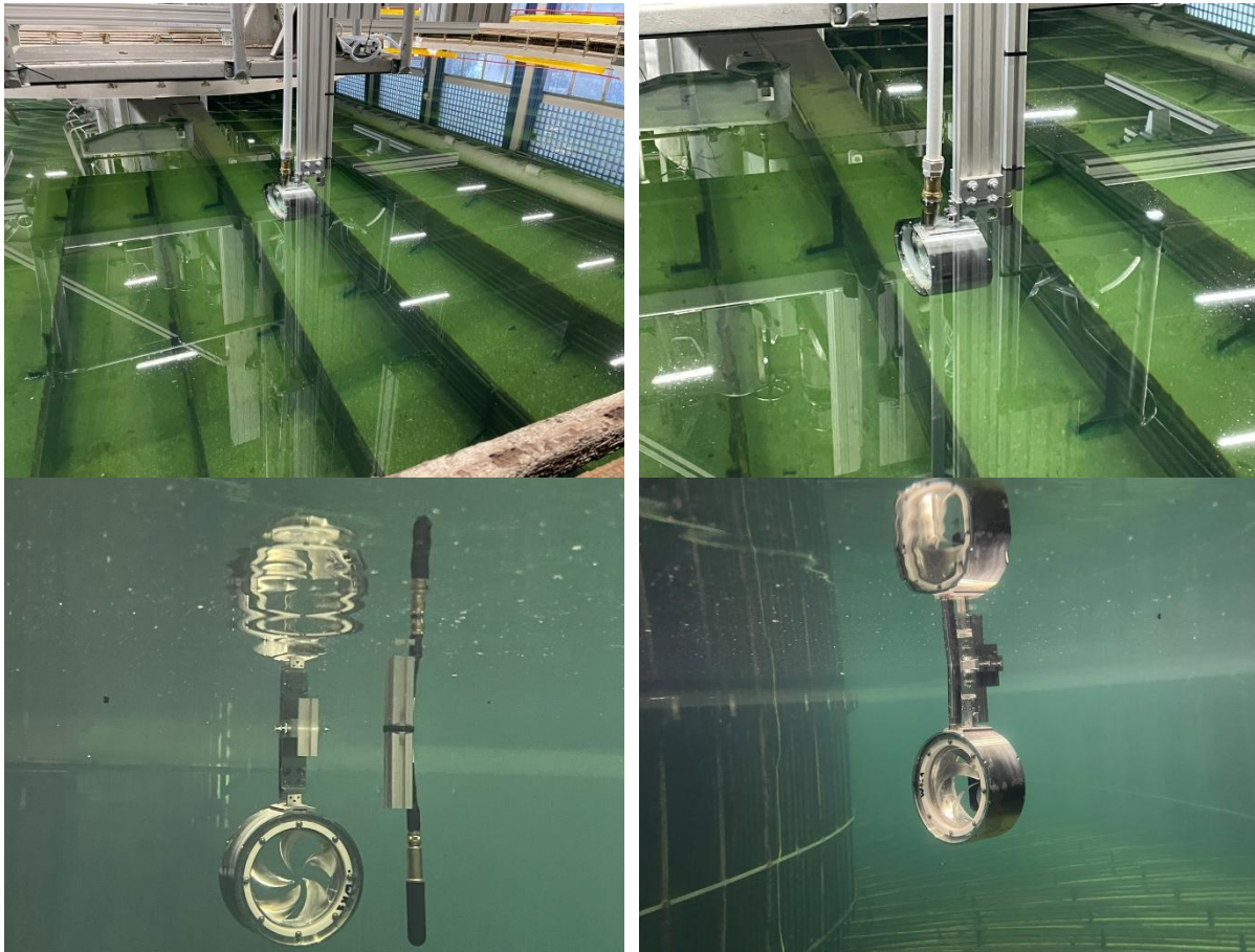
Abb.14 Messaufbau im Rundlaufkanal der Fakultät für Maschinenbau und Schiffstechnik der Universität Rostock Oben: Aufbau fotografiert oberhalb der Wasserlinie Unten: Aufbau fotografiert unterhalb der Wasserlinie
