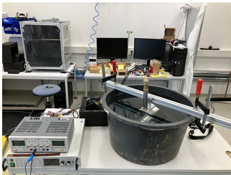
Abb.12 Aufbau für den ersten Inbetriebnahme Test des Thrusters
