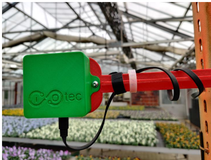
Abbildung 5: UWB-Anker in 3D-gedruckten Gehäuse im Gewächshaus
