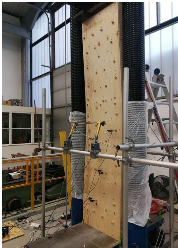
Abbildung 15: W3 im Belastungsversuch; Fotos: FLEX@HTWK-Leipzig, Felix Schmidt-Kleespies
