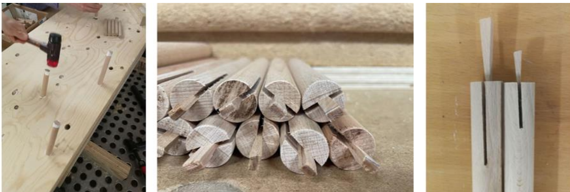
Abbildung 4: Umsetzung verleimter Dübelverbindungen (links), Präparation der Rundhölzer (mittig und rechts), Fotos: FLEX@HTWK-Leipzig, Felix Schmidt-Kleespies
