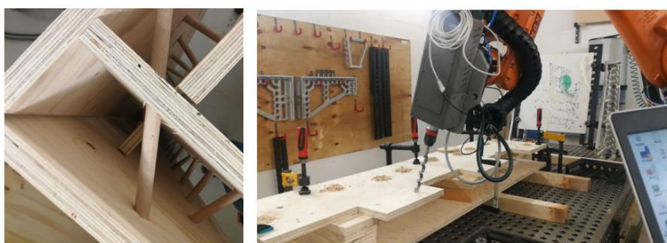
Abbildung 11: Fertigung des Eckelements; Fotos: FLEX@HTWK-Leipzig, Felix Schmidt-Kleespies
