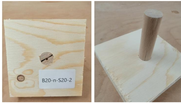
Abbildung 5: Prototyp eines Prüfkörpers für die Ermittlung des Auszugswiderstandes unterschiedlicher Dübelverbindungen; Fotos: FLEX@HTWK-Leipzig, Felix Schmidt-Kleespies
