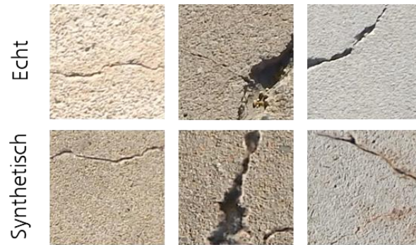
Abbildung 5: Erzeugte synthetische Daten im Vergleich zu echten Bildern. Originalbilder stammen aus dem SDNET2018-Datensatz von Maguire et al. 2018 2 .
