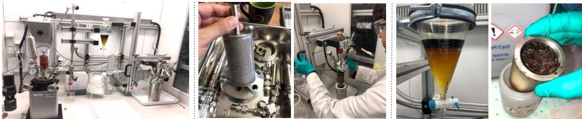
Abbildung 1 Testaufbau der 0,5-L-Reaktoren für den OrganoCat-Prozess (links); Reaction, Stirring & Collection Module (RSCM) (Mitte); Flüssigphasentrennung und Zellstoff im Feststoffkorb (rechts).
