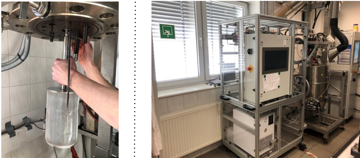
Abbildung 2 Aufskaliertes RSCM für den 10-L-Reaktor (links) und modifizierter hydrothermaler Membranversuchsstand (HTMV) als geschlossenes 10-L-Scale-Up-System zur Biomassefraktionierung (rechts).
