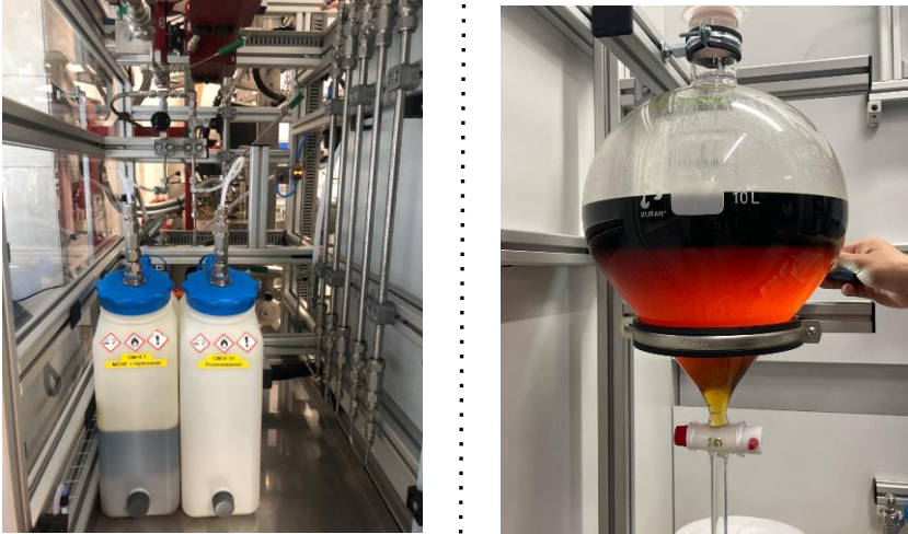
Abbildung 5 Entnahme und Phasentrennung nach der hydrothermalen Biomassefraktionierung: Blick in das modifizierte HTMV-Modul zur sicheren und automatisierten Aufnahme des Reaktionsgemisches in einem geschlossenen System (links) und Phasentrennung der organischen Phase (rechts).
