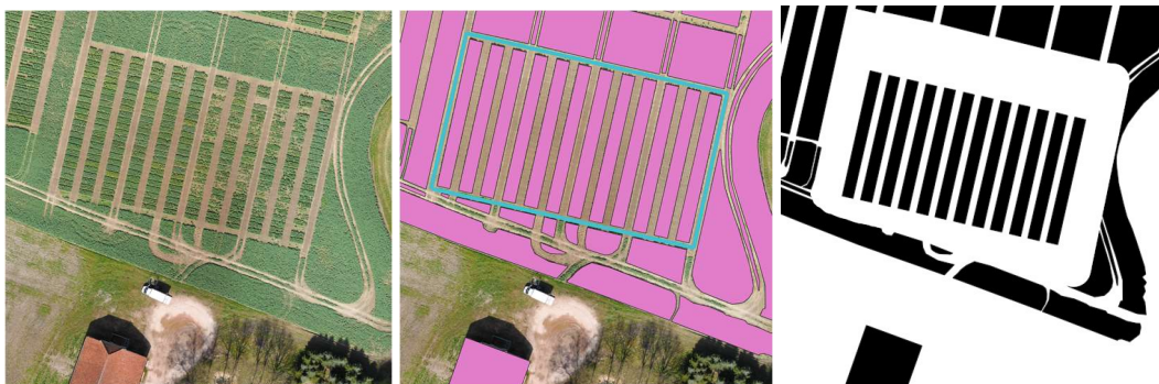
Abbildung 3: vlnr - Drohnenkarte eines der Versuchsfelder, Überlagerung im Geodatentool QGIS, Roboternavigationskarte
