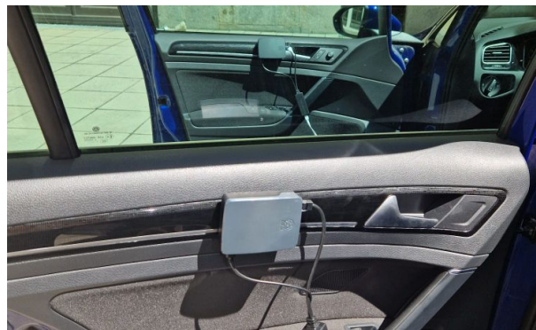
Abbildung 1.2: Demonstrator: Raspberry-Pi-Boards an den Fahrzeugtüren
