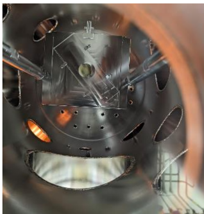
Abbildung 11 Ausgasmessungen von Klebstoffproben. Eine Klebstoffprobe (links) wurde in der OptiVacQ Anlage hinsichtlich Gasrate und Spezies untersucht. Das aufgenommene Massenspektrum zeigt Propan ( C_3H_8 , 44u) als primäre ausgasende Spezies und entsprechende Bruchstücke. Weitere Details in und Grafiken entnommen aus [1].
