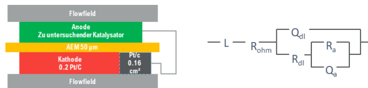
Abbildung 2: Schematische Abbildung der iRE innerhalb der MEA und das angenommene Ersatzschaltbild.
