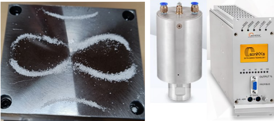
Bild 6: Beispielhaft erzeugtes Schwingungsmuster bei Anregung in Z-Richtung // Komponenten soniKkS
