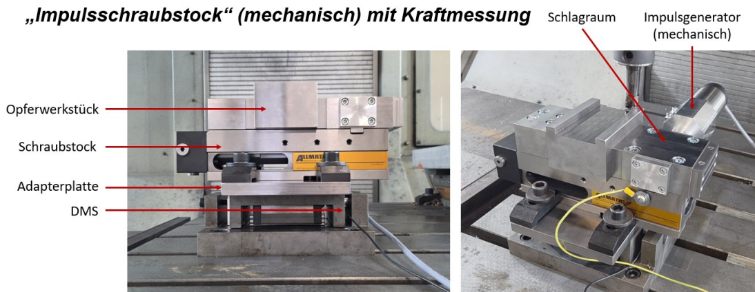
Bild 9: Aufbau des mechanischen Versuchsträger in Kombination mit dem DMS-Messsystem
