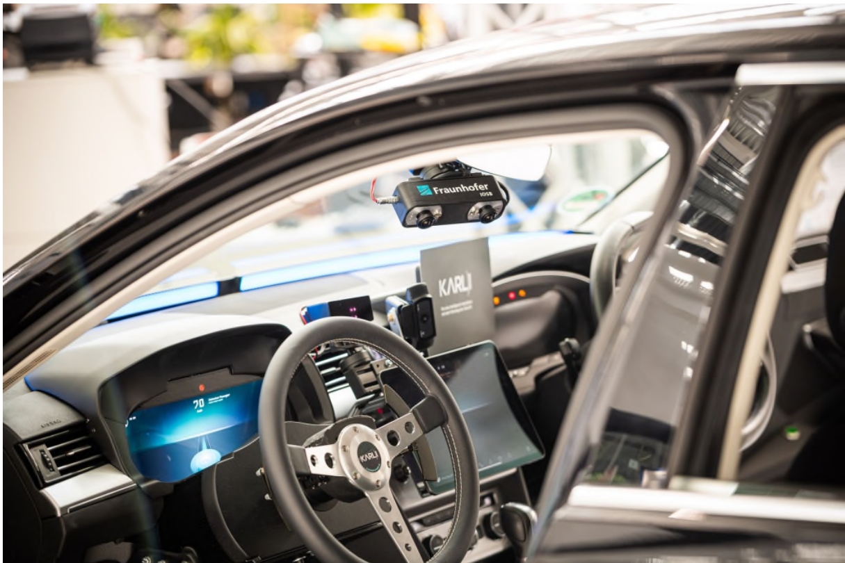
Abbildung 18: Innenraumkamera des Fraunhofer IOSB im Versuchsträger des Projektpartners Continental.
