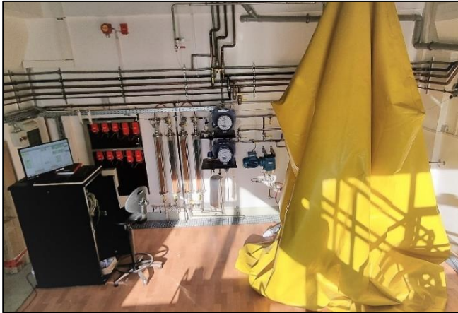
Abbildung 43: kleintechnische Anlage mit angepasster Gasführung und -speicherung (max. 10 m 3 )
