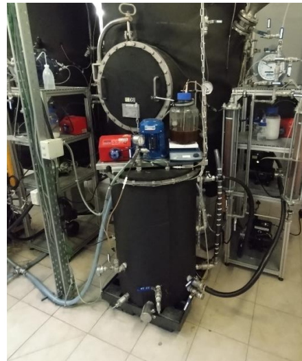
Abbildung 50: Foto der beheizten Substratzugabe der kleintechnischen Anlage
