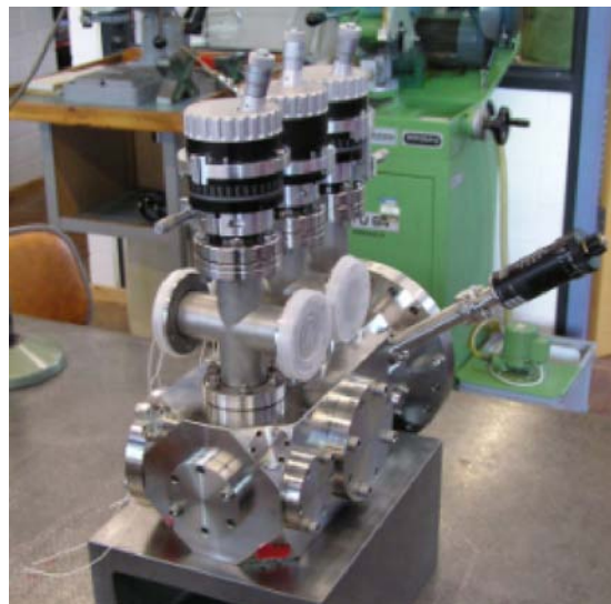
Abb. 7: Mechanischer Aufbau der differentiellen Druckstufe, mit der gespeicherte Nanopartikel selbst bei Atmosphärendruck untersucht werden können. Die Pumpen sind in der Abb. nicht angeschlossen.
