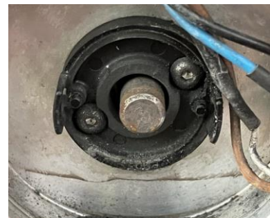
(c) vorgeschrittener Exzentrizität-Schaden
