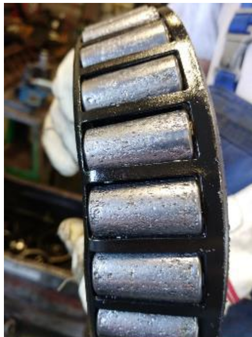
Abbildung 6.4: Verschleißerkennungen an einem Radlager.
