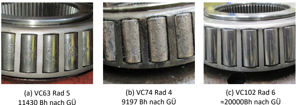
Abbildung 6.26: Rollen des äußeren Radlagers am VC102 Rad 6 im Vergleich
