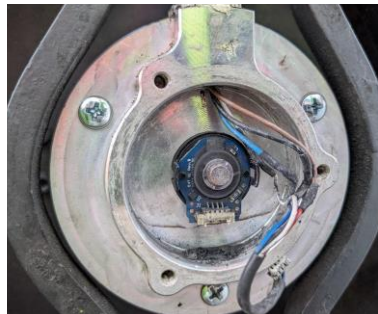
(b) beginnender Exzentrizität-Schaden
