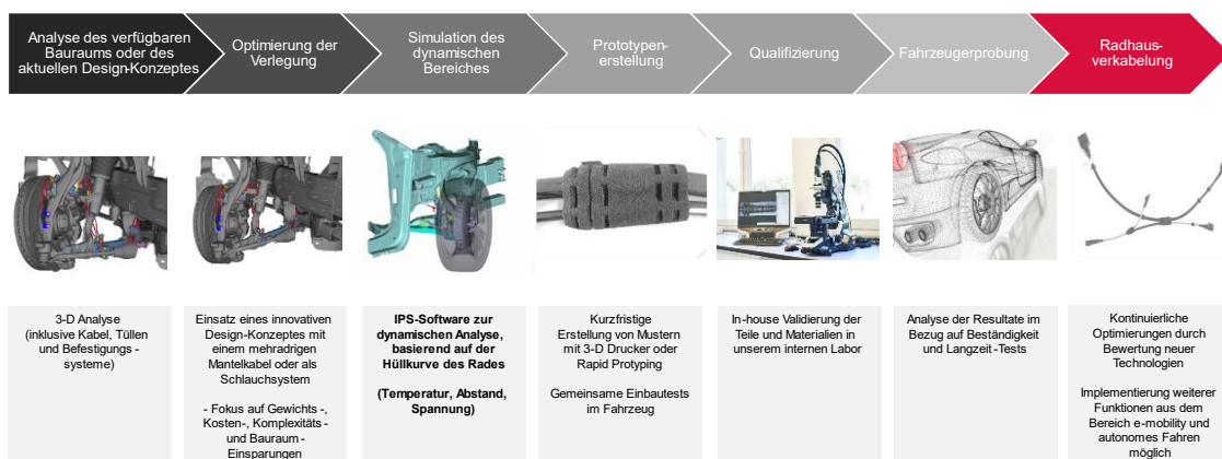
Abbildung 13: Der Leitungssatzentwicklungsprozess: VOBES-Prozess Volkswagen neuer Stand
