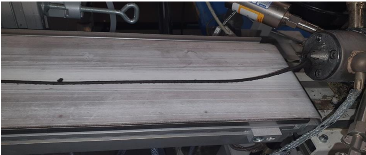
Abb. 4: Compoundierung des Komposits mit dem Ferritpulver Mt114
