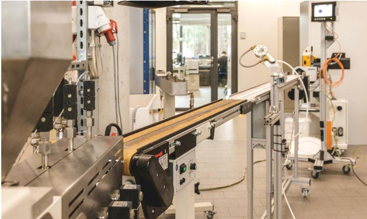
Abb. 5: Vollständig ausgebaute Prozesslinie zur Herstellung hochgefüllter Filamente für FFF inklusive in-line Qualitätsüberwachung
