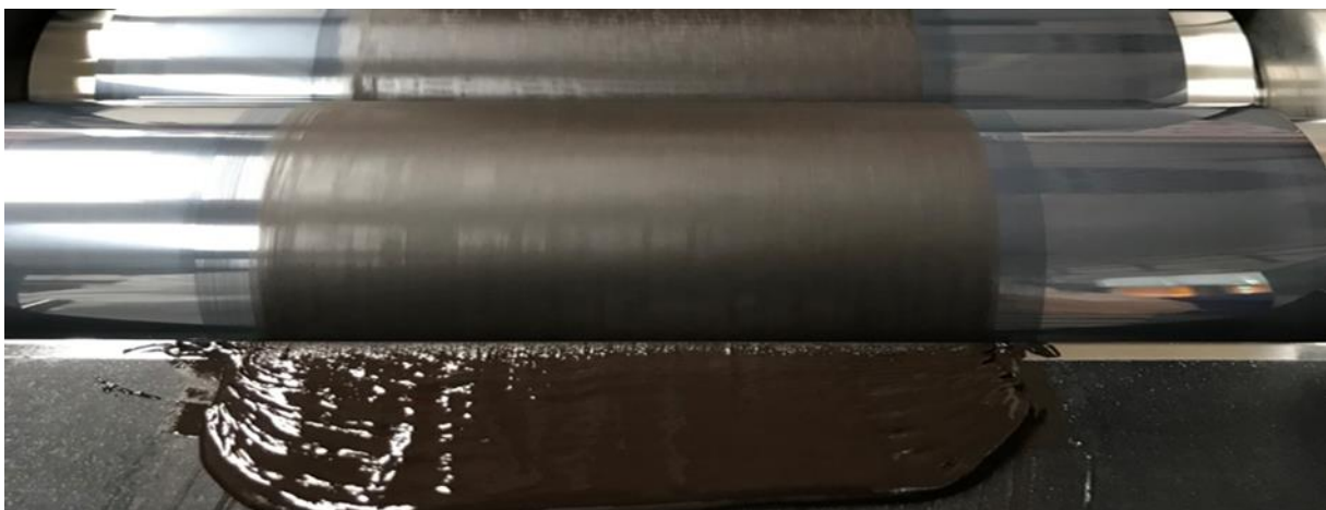
Abb. 8: Ferritpaste auf einem Dreiwalzwerk zur Homogenisierung
