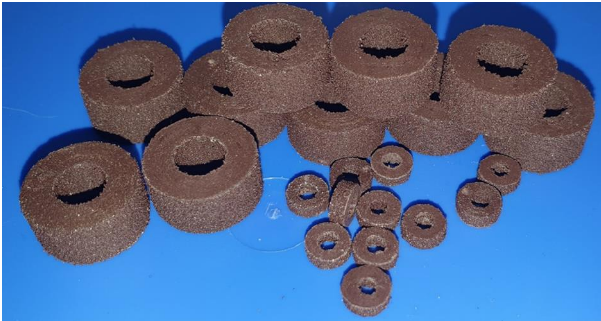
Abb. 13: Gedruckte Ringkerne in den Dimensionen 16x8x8mm und 6,3x3,4x2,5mm mit dem Füllstoff Ni-Zn 90-315 \mu m, raue Oberfläche durch große Partikelgrößen
