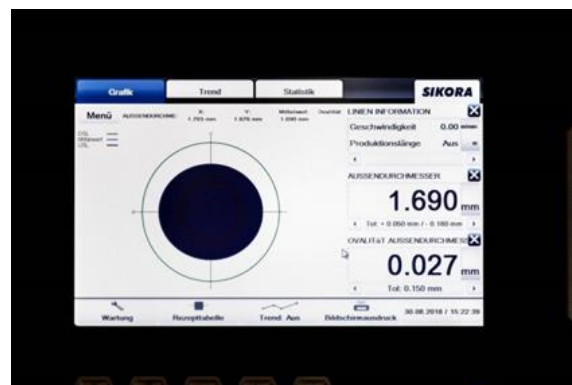
Abb. 6: Modul zur optischen in-line Qualitätsüberwachung der Filamentdurchmesser bzw. Rundheit.
