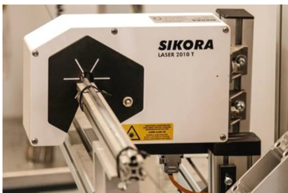
Abb. 6: Modul zur optischen in-line Qualitätsüberwachung der Filamentdurchmesser bzw. Rundheit.
