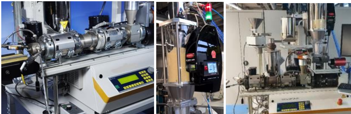
Abb. 2: Compounder mit Drucklufttrockner und Vielfachdosierungen
