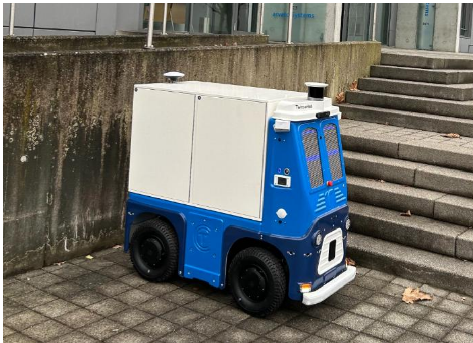
Figure 1 – Autonom navigierende Paketstation am Standort Gütersloh
