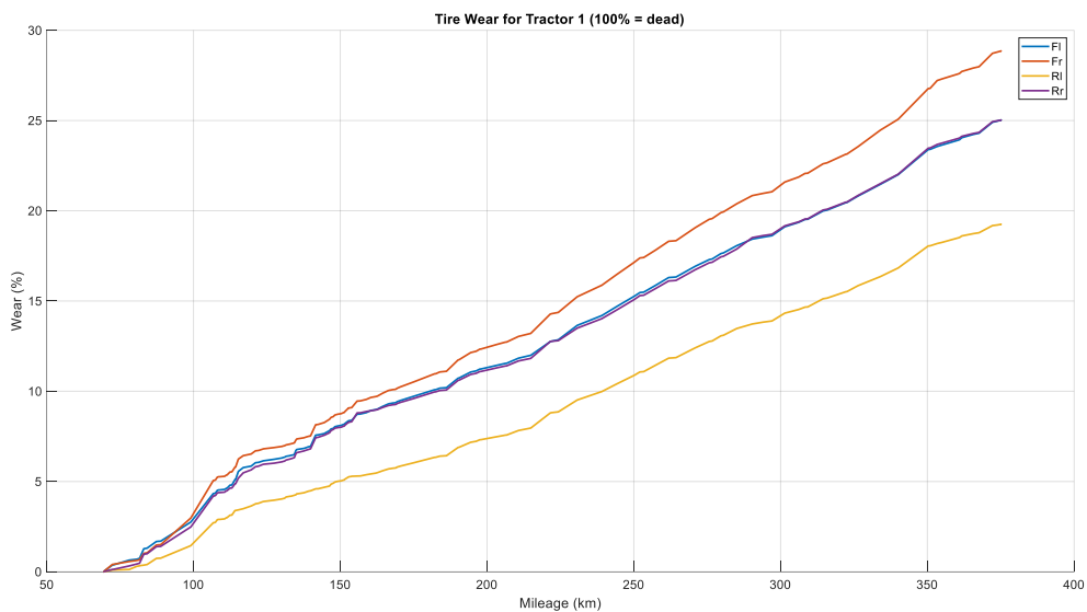
Abbildung 15: Reifenverschleiß Traktor1 (Laufleistung)
