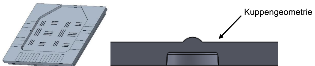
Abbildung 6: links: Werkzeugeinsatz mit Teststrukturen; rechts: Geometrie für Optikintegration
