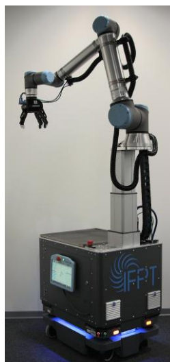
Abbildung 6: Mobiles Robotersystem bestehend aus MiR-Plattform, Liftachse und UR10e-Cobot
