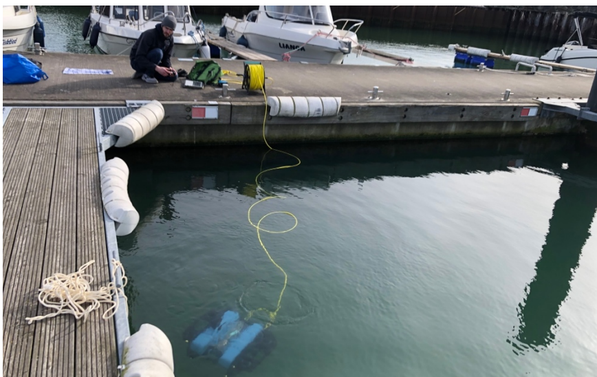
Abbildung 4 – Datenaufnahme im Yachthafen Mittelmole, Warnemünde, mit dem BlueROV2 im Wasser
