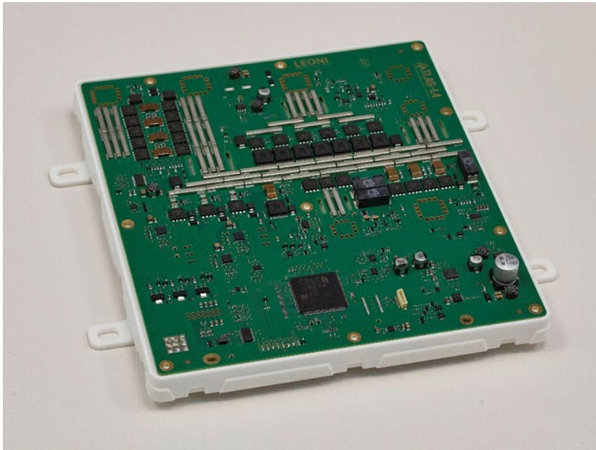
Abbildung 40 Intelligenter Leistungsverteiler (ePDB)
