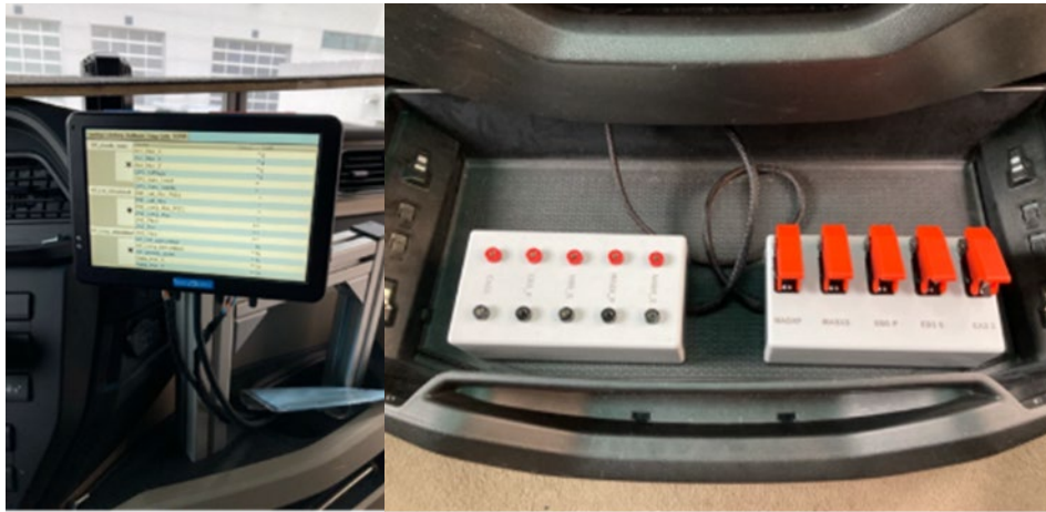
Abbildung 38 Datenvisualisierung und Interfacebox für redundante Systeme
