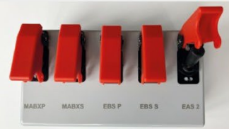
Trennschalter für Redundanz-Komponenten
