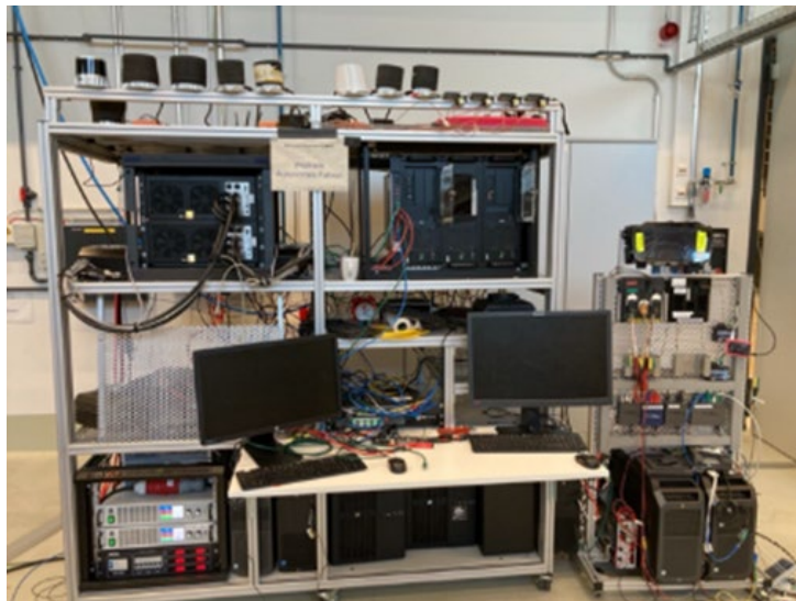
Abbildung 32 Aufbau des HIL-Prüfstands im Labor
