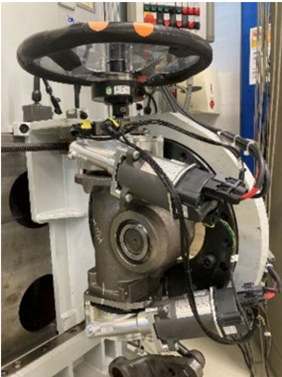
Abbildung 44 Ziellensystem auf dem Prüfstand
