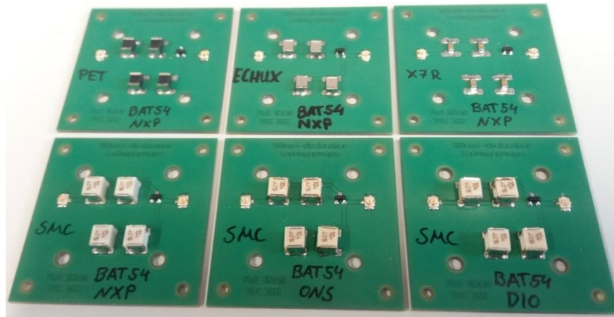
Abbildung 21: PCBs mit einem Villard-Greinacher-Gleichrichter in unterschiedlichen Ausführungen
