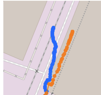
Abbildung 4: Abweichung der GNSS-Position (blau) und der fusionierten Position (orange) innerhalb der Waschhalle [Quelle: Projektergebnisse ELFE, siehe auch Berichte der Projektpartner]
