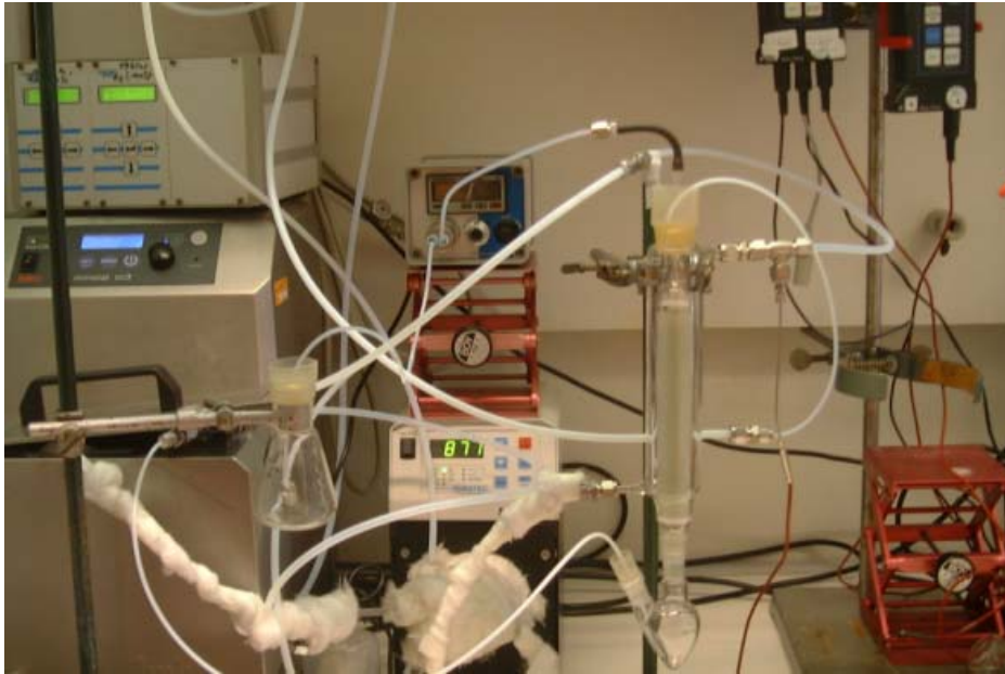
Abb. 26 Photo des für die Ozonierung von 1-Decen eingesetzten Rieselbettreaktors.
