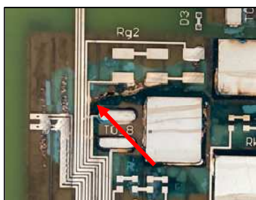
Abbildung 15: Harzmangel und Delaminierungen ZVT
