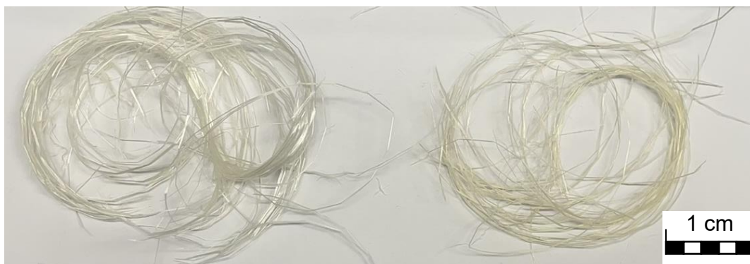
Abb. 3.5: Gesponnene und getrocknete Multifilamentfasern aus der Laborspinnanlage, Spinnlösung Keratin:Glucan links 1:3 und rechts 1:1. [Kro25]
