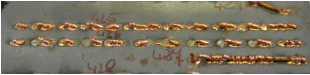
Abbildung 1-5: Schweißnähte aus CuAg1 mit ungenügender Qualität
