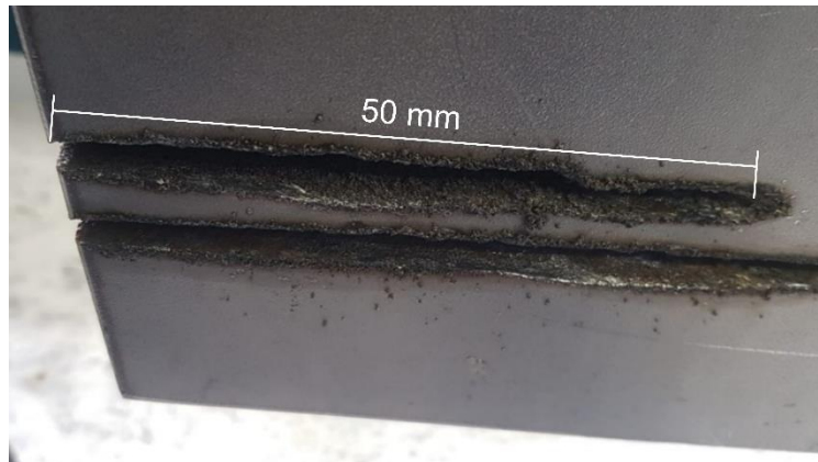
Abbildung 2-17: Schnittfugen in Mock-ups zur näheren Prozessuntersuchung
