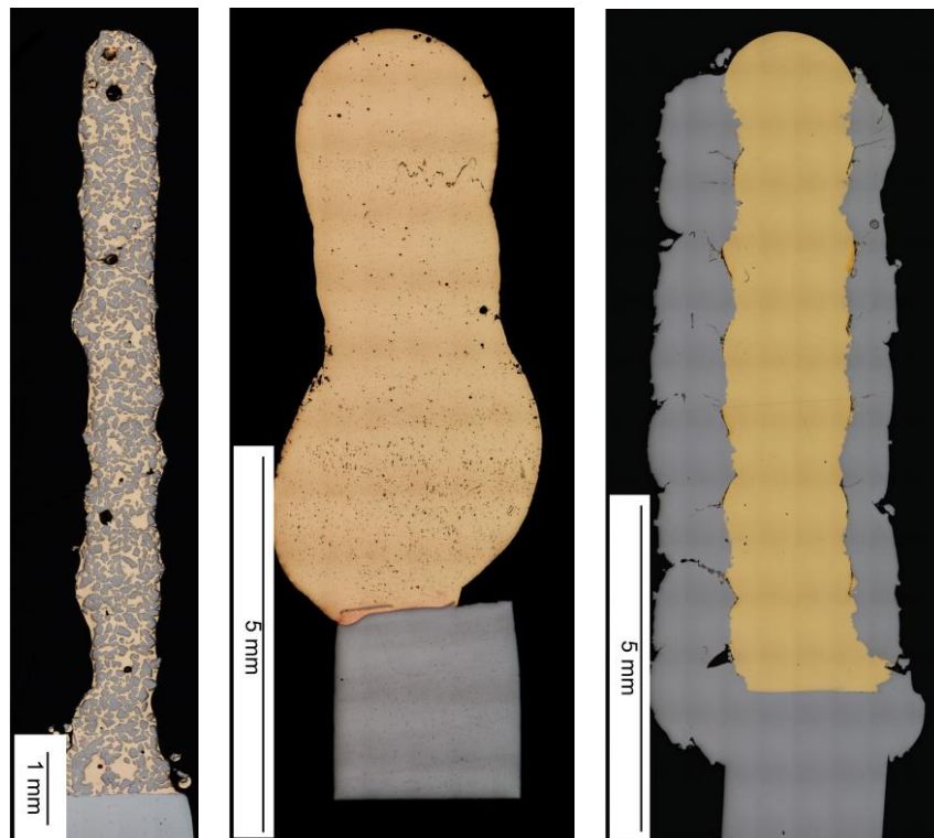
Abbildung 1-7: Realisierung von Verbundkonzepten mit einem Teilchenverbundwerkstoff aus \text{CuSi}_3 und WSC (links), Faserverbundwerkstoff aus \text{CuSi}_3 und C-Fasern (mitte) und Schichtverbundwerkstoff aus \text{CuAl}_7 und \text{CoCr}_2\text{8W}_2\text{Ni} (rechts)
