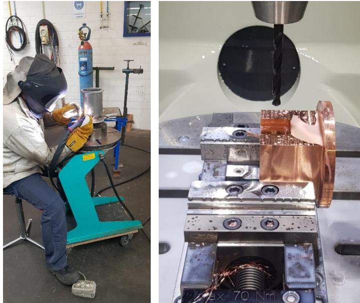
Abbildung 2-10: Schweißungen für die Gehäuseteile (links), spanende Fertigung des Stromübertragungsmoduls (rechts)
