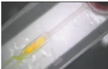
Abbildung 9: Plasmaseparation mit Filterstrukturen (rev. 7.2) auf dem mit Reagenzgemisch beschichteten Gold-Substrat (Sensor). Das Plasma ist nach dem Austritt aus der Messkammer durch das Reagenzgemisch gelb gefärbt.
