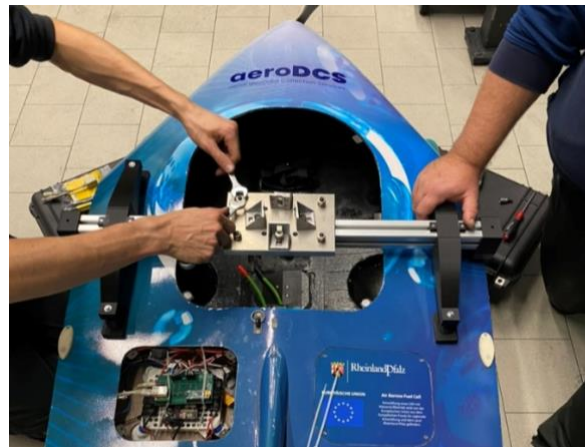
Abbildung 5: : Installation des Befestigungssystems am VTOL
