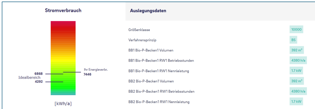
Abbildung 34: Auszug, Auswertung Rührwerke BIO-P Becken, Quelle: Klärwert
